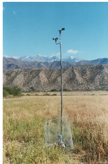
Figura 3. Anemómetro de cazoleta y veleta NRG que actúan como medida de referencia.
