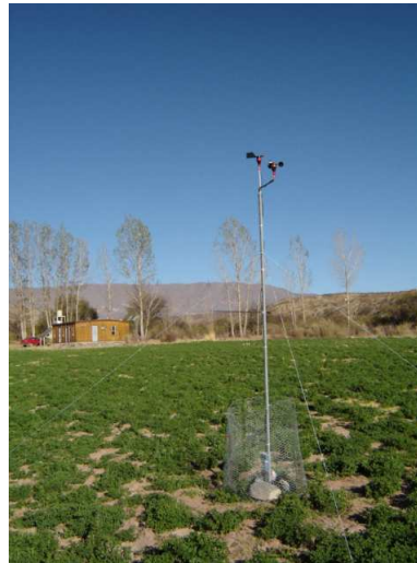
Figura 3. Anemómetro de referencia y veleta. Se observa la pared oeste del refugio y parte de la barranca Sur.
