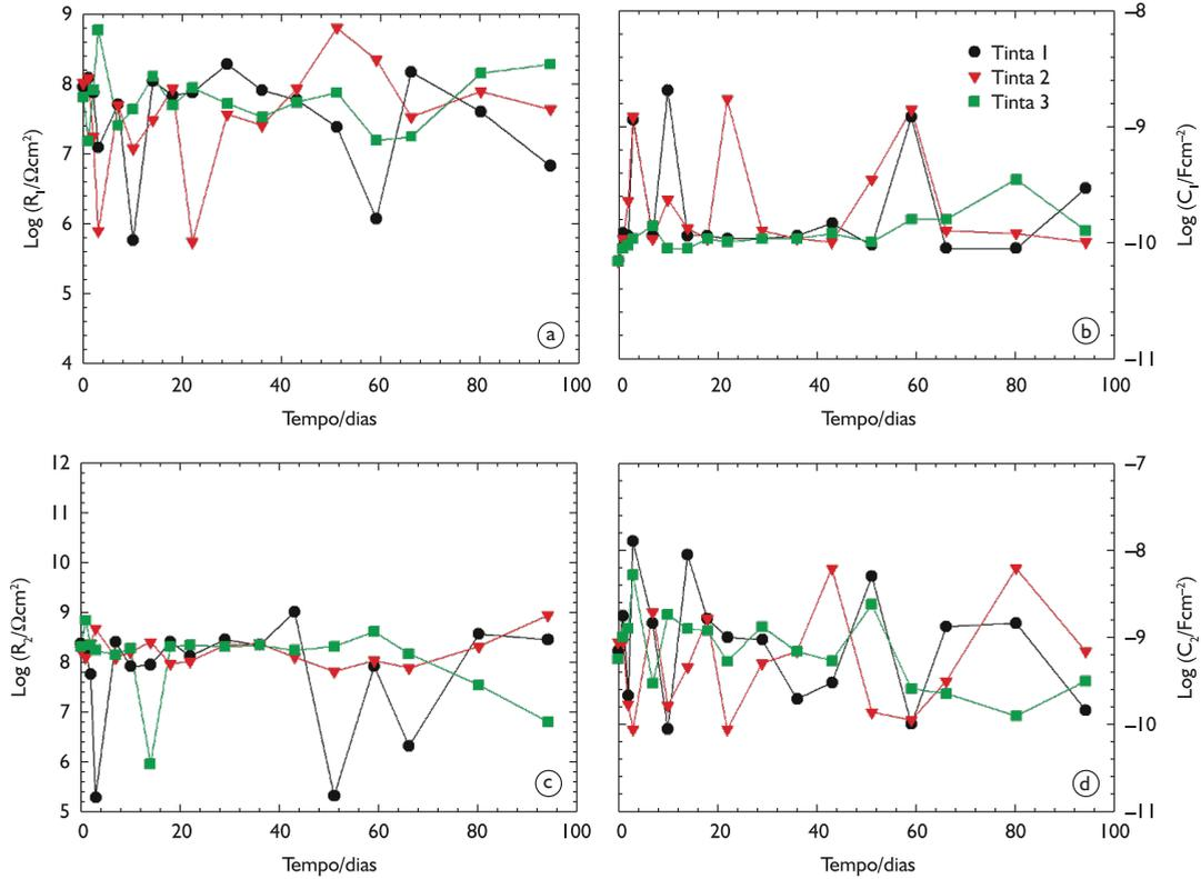
**Figura 5.** Evolução dos parâmetros: (a) log R<sub>p</sub>, (b) log C<sub>1</sub>, (c) log R<sub>2</sub> e (d) log C<sub>2</sub>, para o sistema Zn – Cr VI – revestimento orgânico pintados com três tintas, após imersão em solução 0,05 mol/L de NaCl.
