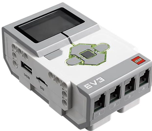
Joonis 2.2 LEGO Mindstorms EV3 juhtblokk [21]
