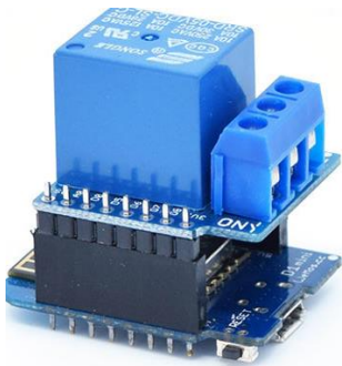
Joonis 47. Relee laiendusplaat WeMos D1 Mini külge ühendatud [97].
