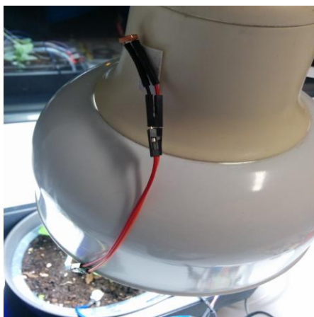
Joonis 38. Fototakisti kahepoolse teibiga lambi külge kinnitatud.
