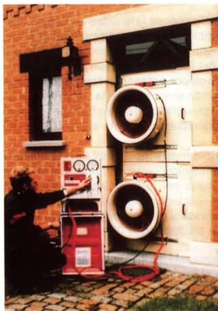
Fig. 3.—Determinación de la estanquidad al aire de una habitación. Ensayo realizado en el CSTB de Bélgica.
