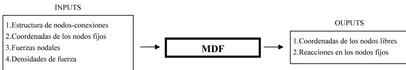
Figura 2. Esquema de INPUTS - OUTPUTS en el MDF.
