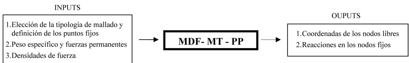
Figura 4. Esquema de inputs - outputs en el MDF-MT-PP.
