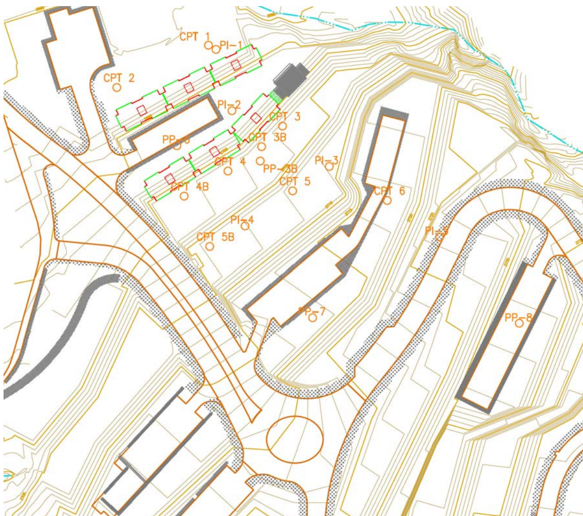
Figura 4. Sondeos realizados por Edifica Colombia Ltda. PI: perforación con inclinómetro; PP: perforación con presurómetro; CPT: sondeo con piezocono.
