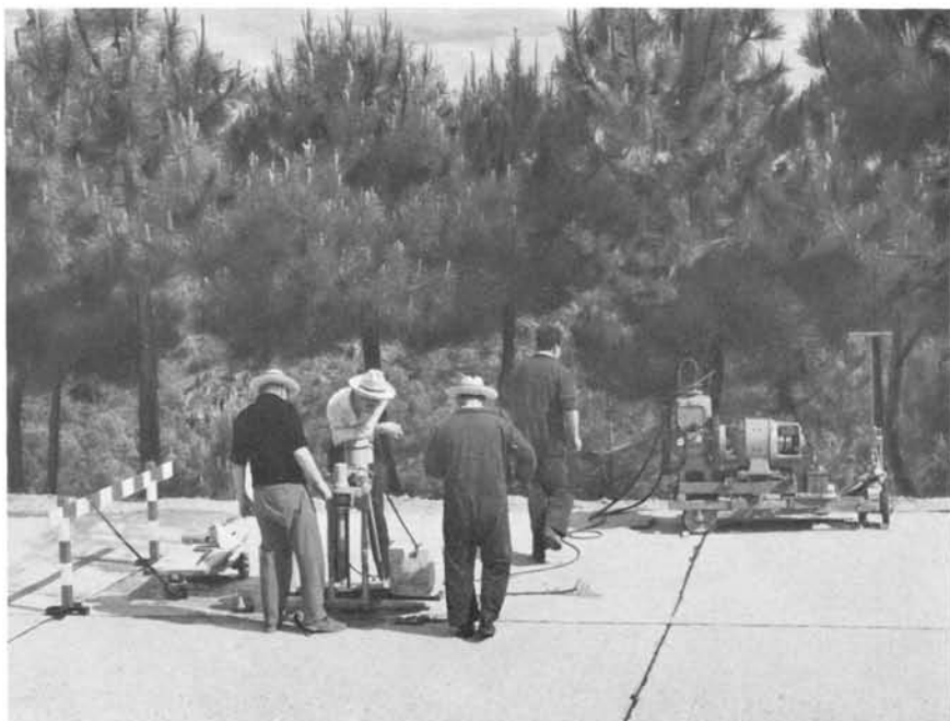
Fig. 2. Extracción de probetas-testigo en uno de los tramos antiguos en buen estado.
