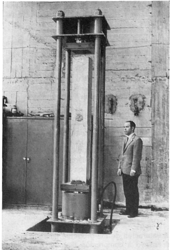
Foto 3. Prensa construida para la rotura de pilares.
