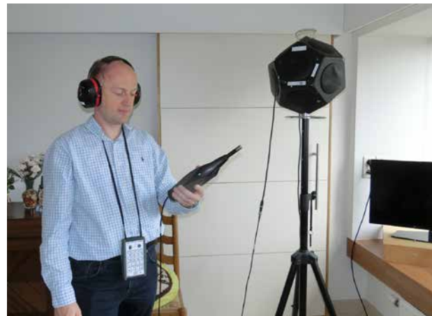
Figuur 3.1 Meting van de luchtgeluidsisolatie (geluidsniveau in de zendruimte).
