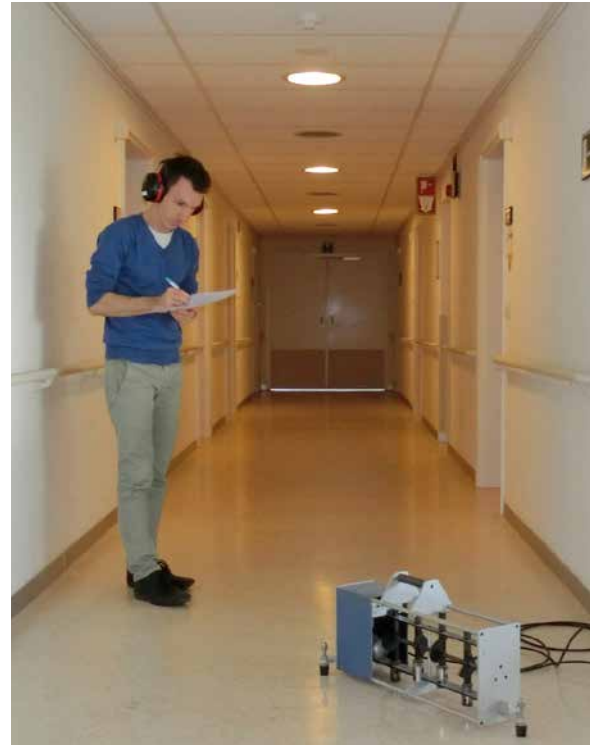
Figuur 3.3 Meting van de contactgeluidsisolatie met klopmachine.
