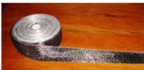
Figura 5 - Laminado de fibra de carbono bidirecional (MOHAMMAD et. al. 2011).
