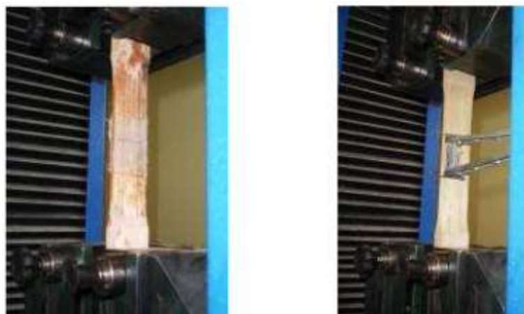
Figura 6 - Esquema de ensaio da peça sem laminado e com laminado (MOHAMMAD et. al. 2011).
