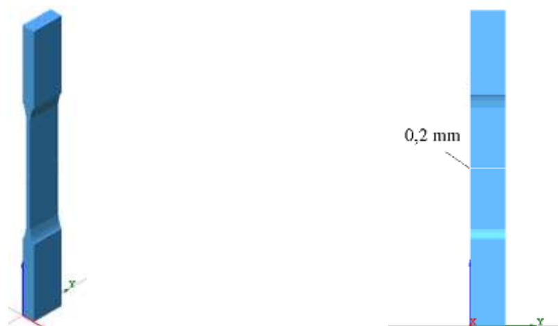
Figura 9 – a) Geometria em volume; b) Face frontal mostrando a distância de 0,2 mm representando o corte da peça
