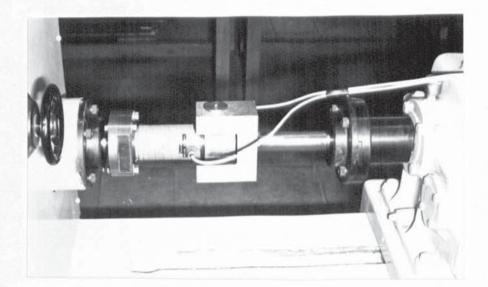
Plate 7 :- CALIBRATION OF TORQUE BRIDGE
