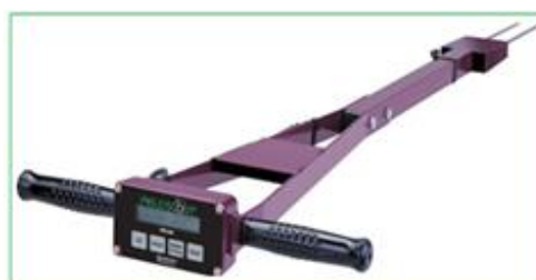
Fig. 2. FieldScout moisture analyzer
