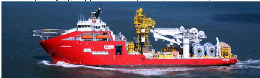
Figura 10: Pipe Laying Support Vessel (PLSV) - Embarcação Skandi Niterói
