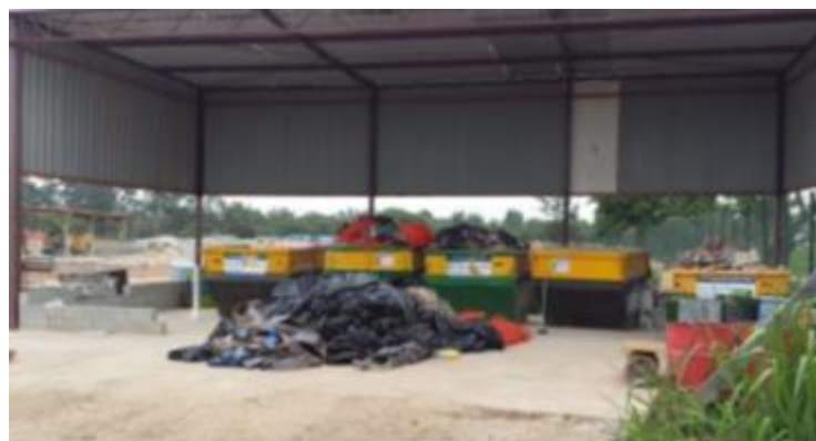
Figura 9 - Acondicionamento de Resíduos por Classes em local de armazenamento (Central de Resíduos) coberto e protegido de chuva
