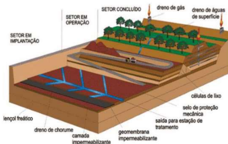
Figura 1: Configuração de um aterro sanitário.
