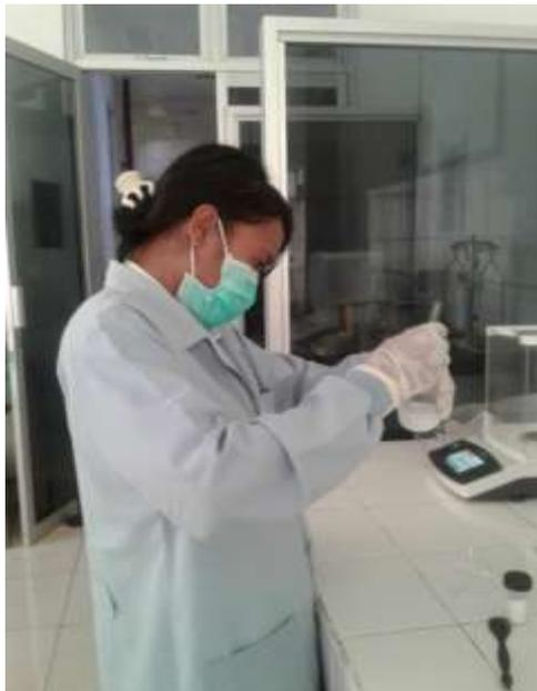
Melakukan pengenceran  $\text{Na}_2\text{EDTA}$  dengan aquadest 100 ml
