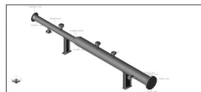
Gambar 2 Model Pig Launcher pada Software PV ELITE
