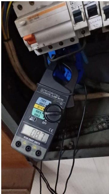
Gambar 3. Sensor dan Alat Ukur yang Sudah Dikaitkan pada Kabel MCB
