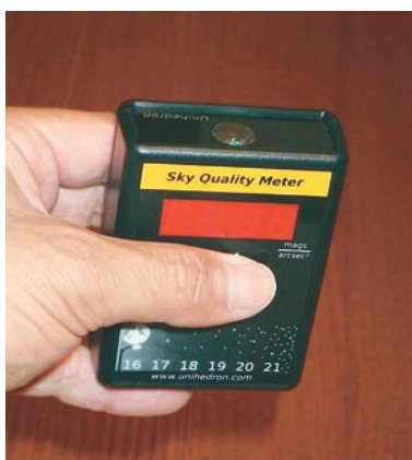
図2. Unihedron社のスカイ・クオリティ・メーター（SQM-L）。大きさは手のひらに収まる程度で重量も100g程度と非常に軽く持ち運びに便利である。測定するにはSQM-L上部に見えるレンズ部分を測定したい方向に向けて（写真中の親指の下にある）ボタンを数秒押すだけで、夜空の暗度が \text{mag arcsec}^{-2} で表示される。
