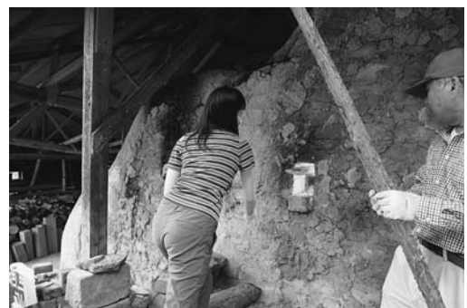
指導を受けて連房式登り窯に薪を投入する
