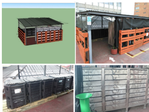
Figura 3. Planta para el procesamiento de residuos orgánicos
