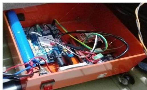
Gambar 4. alat pengaman koper dengan GPS berbasis mikrokontroler dengan output SMS
