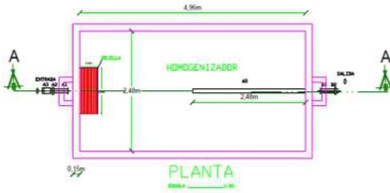
**Figura 7:** Diseño del tanque homogenizador
