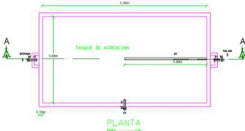
**Figura 9:** Diseño del tanque de aireación
