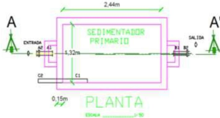
**Figura 8:** Diseño del sedimentador primario
