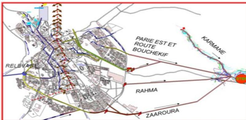
**Figure.2.** Schéma directeur des principaux collecteurs de la ville de Tiaret vers la station d'épuration (step, 2007)
