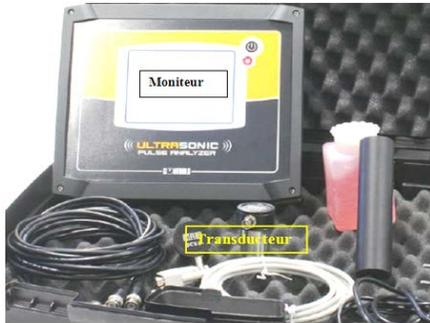
Figure 5 : appareil d'auscultation *Pulsonic*
