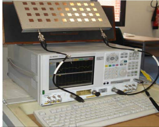
Figure 11. Banco de medida con el Analizador de Redes
