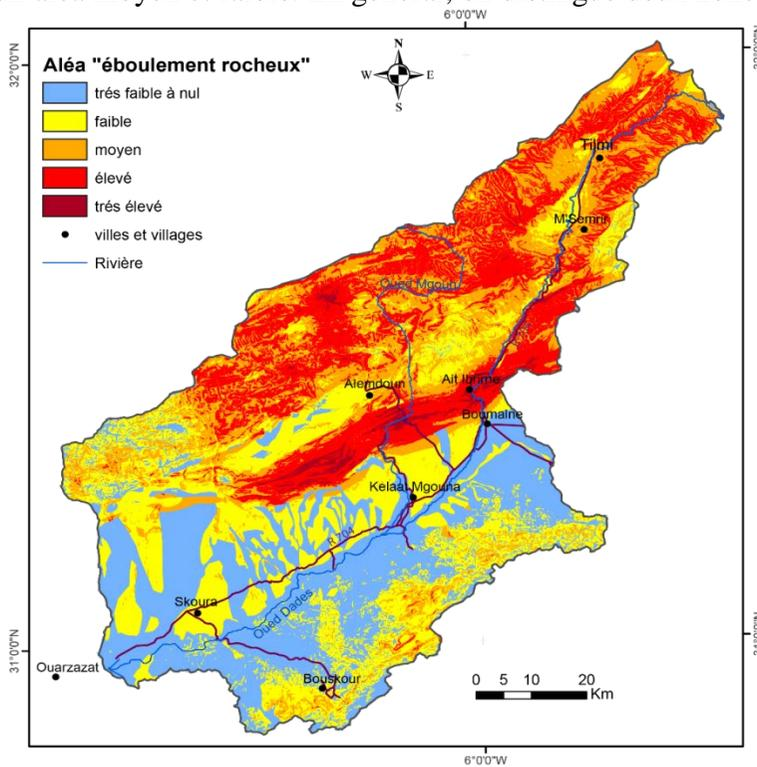
Figure 10 : Carte d'aléa éboulement des masses rocheuses.
