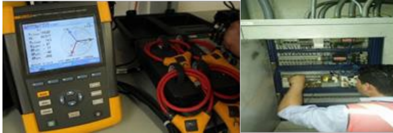
Figura 2. Etapa de medición con analizador de red Fluke
