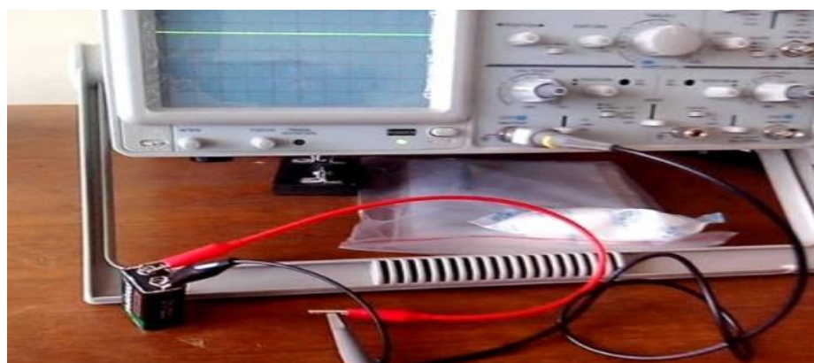
Gambar 2 HasilTegangan Keluaran Baterai 9 Volt
