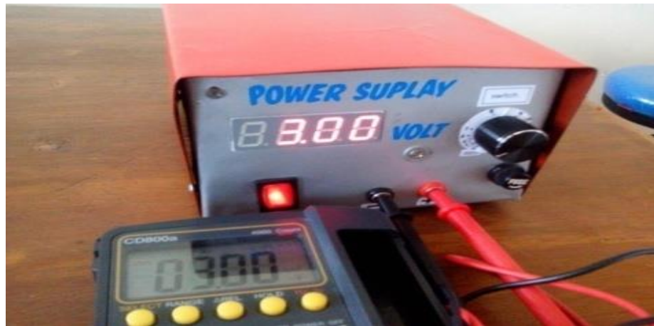
Gambar 6 Hasil Tegangan Alat Ukur Standar dengan Alat Ukur yang Dibuat
