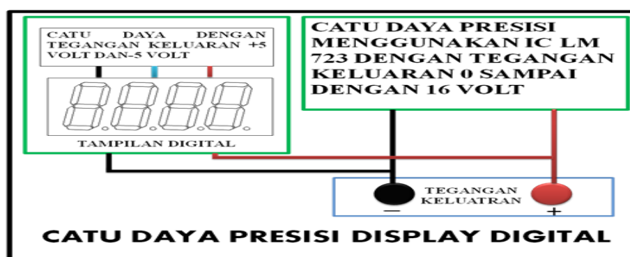
Gambar 3. Blok Catu Daya Presisi Display Digital
