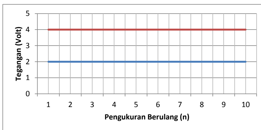
Gambar 9. Grafik Pengukuran Berulang terhadap Tegangan Keluaran Catu Daya
