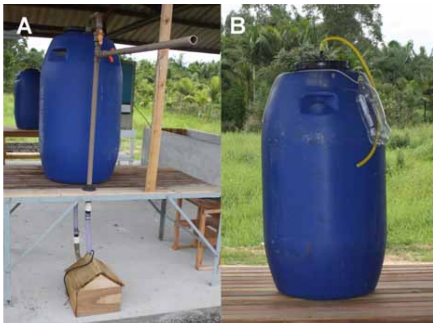
Figura 3. Biofermentadores na unidade didática de produção de biofertilizantes na Epagri/EEI: (A) fermentador aeróbico; (B) fermentador anaeróbico
