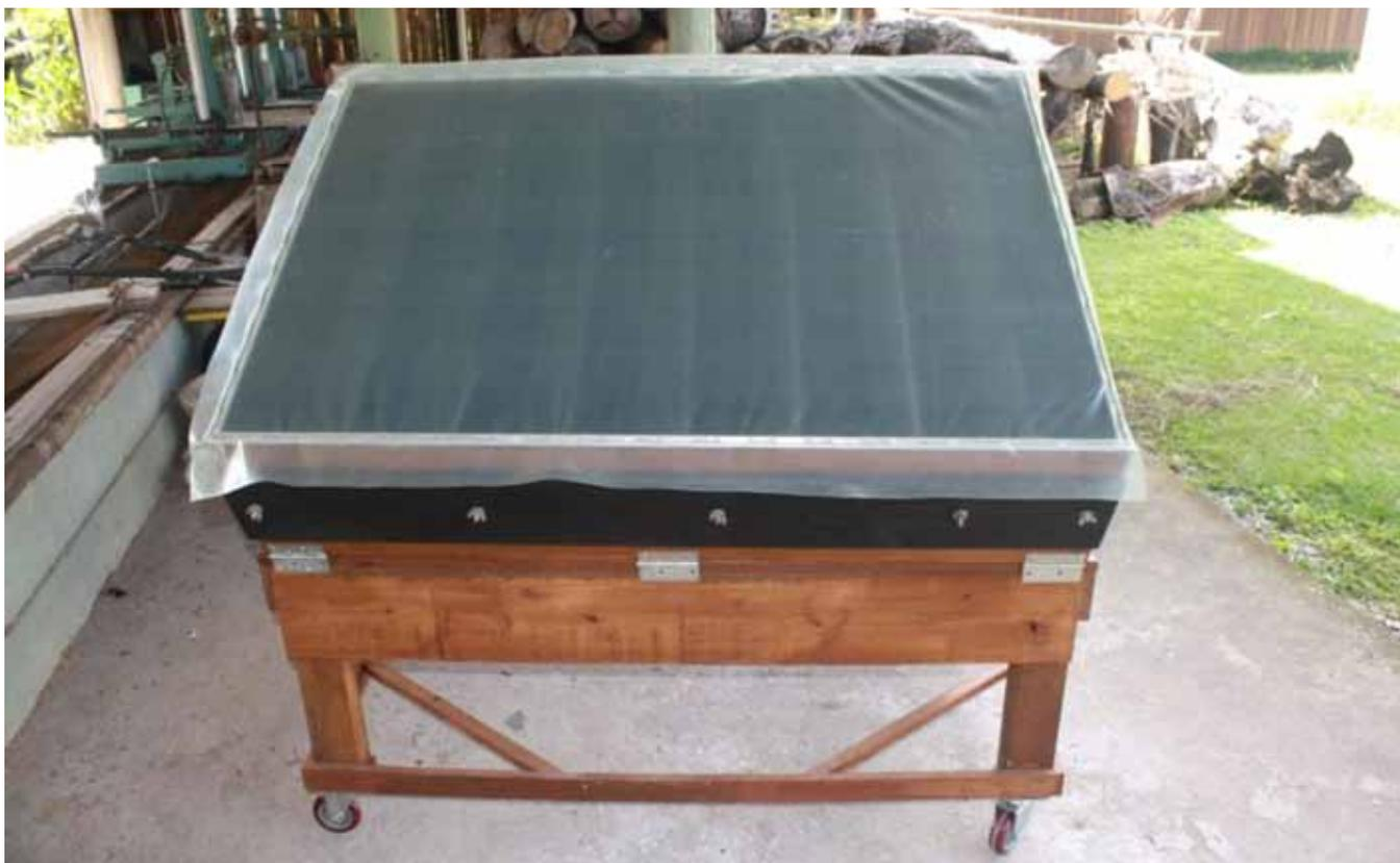
Figura 5. Coletor solar para desinfestação de substrato
