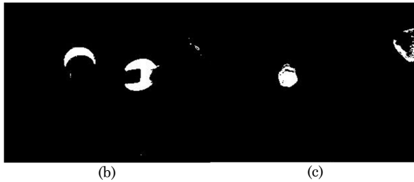
Fig. 2. Imágenes obtenidas luego de segmentar la imagen original (a), la llave (b), y la tuerca (c). Fuente: Autores
