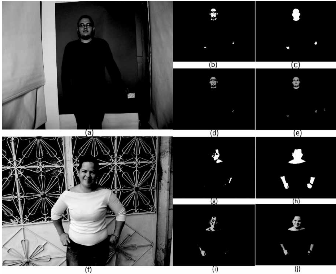
Figura 6. Comparación de métodos de segmentación de piel. (a) Imagen original con iluminación controlada, (b) Color de Piel en RGB de una imagen controlada, (c) Histograma de Referencia en imagen controlada, (d) Distancia Euclidiana en imagen controlada, (e) Distancia de Mahalanobis en imagen controlada, (f) imagen original con iluminación no controlada, (g) Color de Piel en RGB de una imagen no controlada, (h) Histograma de Referencia en imagen no controlada, (i) Distancia Euclidiana en imagen no controlada, (j) Distancia de Mahalanobis en imagen no controlada.
