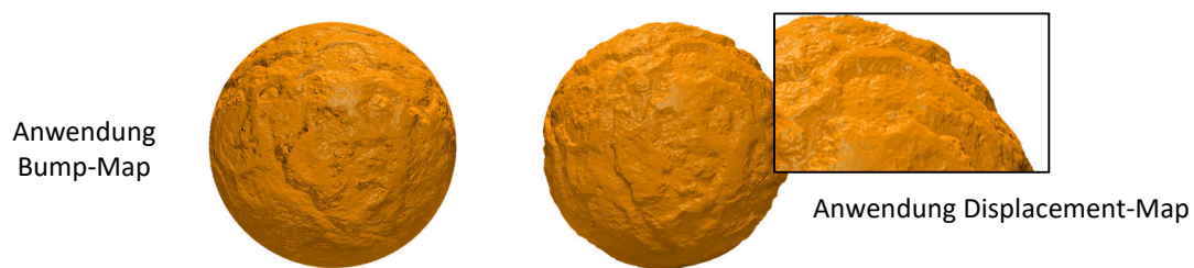
Bild 4-36: Wirkungsweise von Bump- und Displacement-Maps am Beispiel einer Kugel
