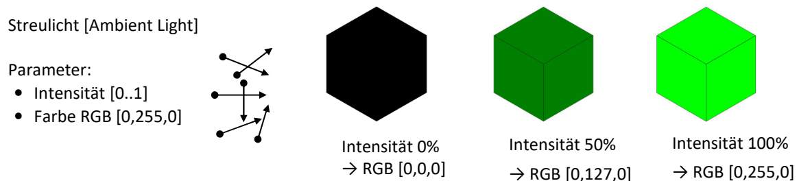
Bild 4-26: Zusammenhang der Parameter Lichtfarbe und -intensität bei Streulichtquellen
