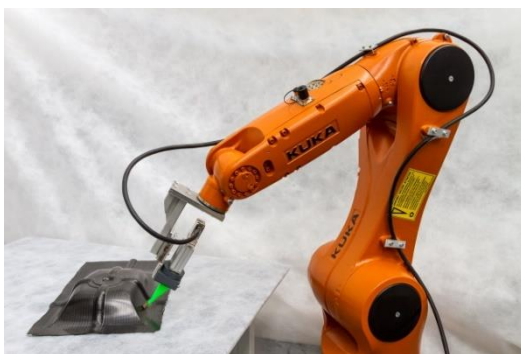
Abb. 7-3: 3D-Wirbelstromprüfung am CFK-Bauteil Federdom
