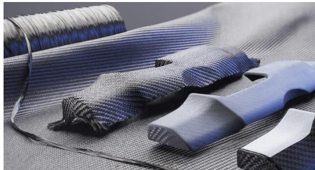
Abb. 2-1: RTM-Prozesskette, von links nach rechts: Carbonfaserbündel auf Spule, Carbonfasergewebe, trockene 3D-Preform, CFK-Bauteil und CFK-Bauteil nach Endbearbeitung (Bildquelle: [27])
