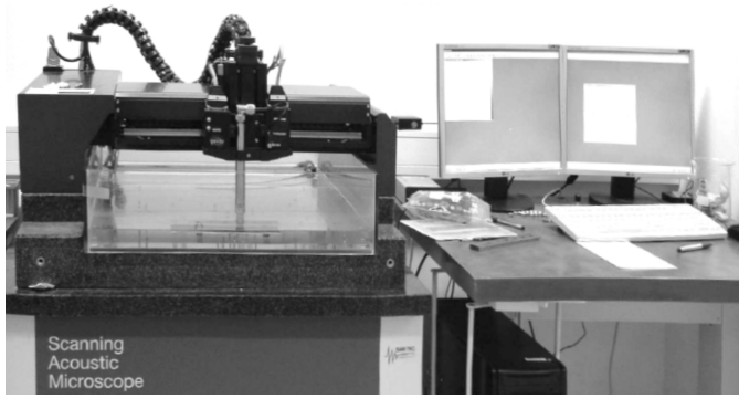
Abbildung 4.15.: Versuchsaufbau bei der Ultraschallprüfung am Fraunhofer IKTS in Dresden Klotzsche
