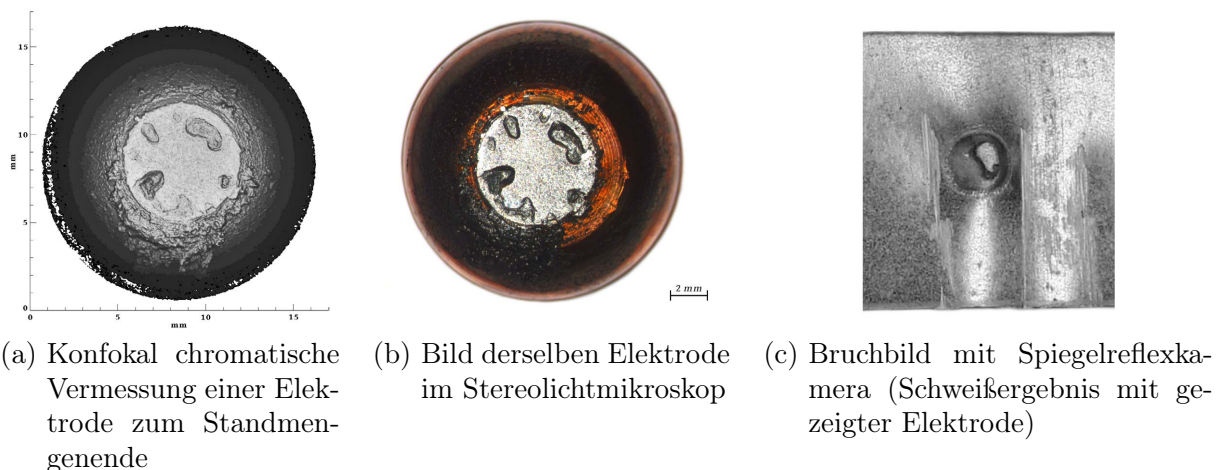
Abbildung 5.9.: Echtfarbdokumentation für Elektrodenkontaktfläche und Bruchbild
