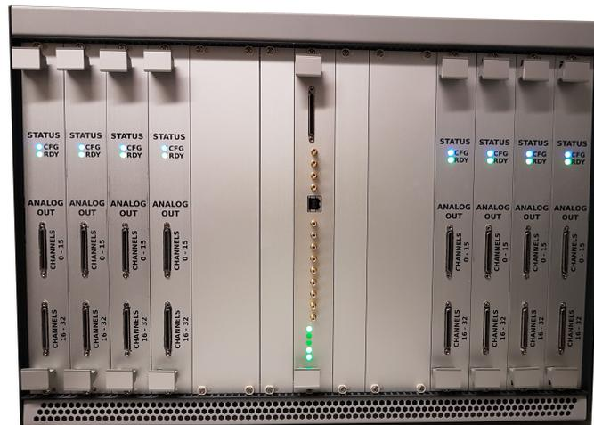
Abbildung 5.2: Foto des PAUDV: 19-Zoll-Baugruppenträger mit der Steuereinheit (Mitte) und acht Transceivermodulen.
