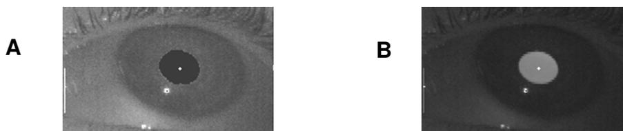
Abb. 4-2: Videokamerabilder nach dem *dark-pupil* Effekt (A) und dem *bright-pupil* Effekt (B). Unterhalb der Pupille ist der Cornea-Reflex als punktförmige Reflexion der Infrarotlichtquelle an der Cornea-Oberfläche zu erkennen.
