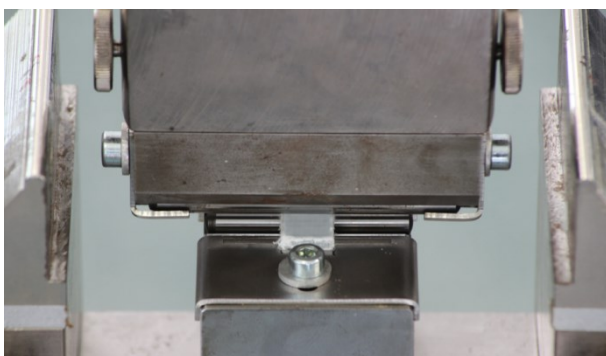
Abb. 4-8 Einlagig verstärkter Prüfkörper in der Prüfvorrichtung für die Bestimmung der scheinbaren interlaminaren Scherfestigkeit
