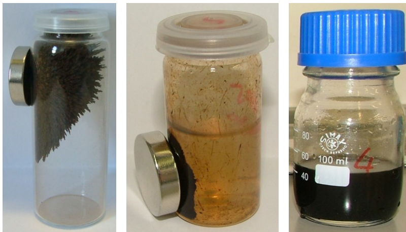
Abb. 4-16 Synthetisierte Magnetitpartikel; getrocknet, in wässriger Dispersion (jeweils unter Einfluss eines Permanentmagneten), sowie stabilisiert mittels Ölsäure in Toluol (von links)
