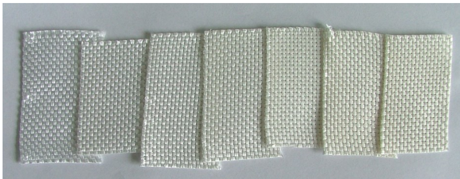
Abb. 5-20 Vergilbung unterschiedlich stark plasmabehandelter UHMWPE-Gewebe an Umgebungsluft; unbehandelt bis 12 min (von links)
