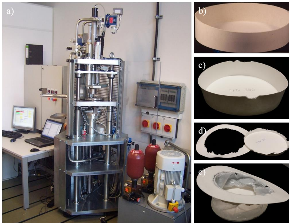
Abb. 3.2: a) Kartontiefziehversuchsstand und b) einwandfreie sowie c) - e) fehlerhafte Ziehteile
