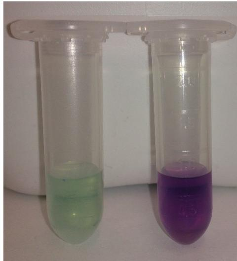
Abbildung 22 Färbung der Überstände nach BCA-Test, links: unbeladenes Sol-Gel, rechts: beladenes Sol-Gel.
