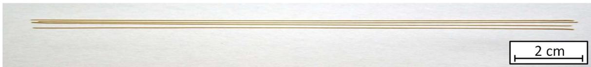
Abb. 3.1: PZT-Fasern mit einem mittleren Durchmesser von 290  $\mu\text{m}$
