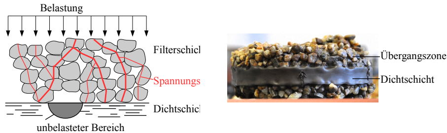
Abbildung 5: Links: Angenommene Spannungsverteilung im Filtermaterial und daraus resultierender Oberflächenzerfall, Rechts: Bildung von präferierten Fließwegen durch lokale Ausspülungen
