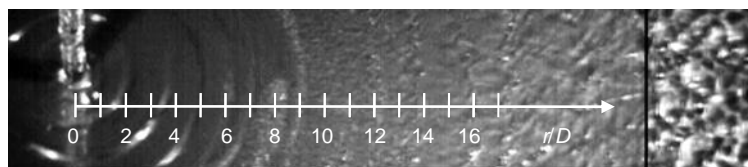
Abbildung 3: Typische Strukturen an der Oberfläche des Wandstrahls; Betriebspunkt D = 3,3 mm, p_D = 0,5 bar, L = 100 mm, Re = 35600 . Der hydraulische Sprung ist mit einer schwarzen Volllinie markiert.
