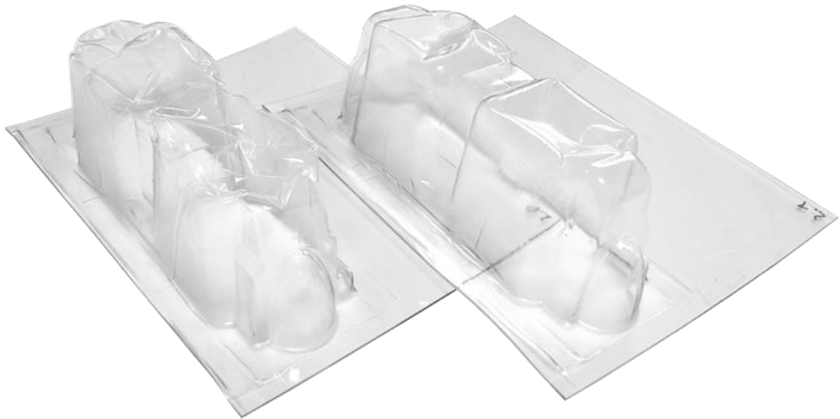
Abbildung 8 Verpackungsmuster nach Stauchdruckprüfung: links mit Ausgangswanddickenverteilung, rechts mit optimierter Wanddickenverteilung
