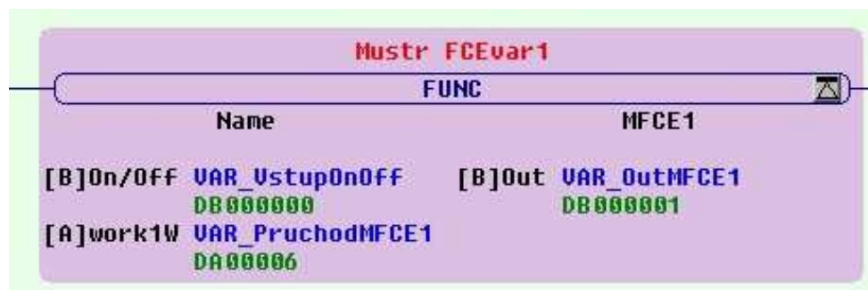
Bild 1 Benutzerfunktion (Eingänge, Ausgänge und Kommunikation, MFCE1 in PLC)
