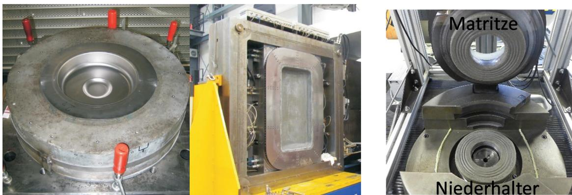
a) Betonwerkzeug [10]   b) IHU Werkzeug [10]   c) Mineralgusswerkzeug [4]
