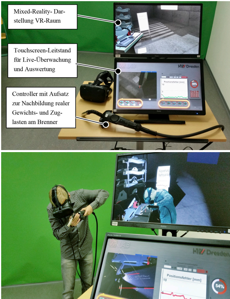
Abbildung 1: oben: Lehrumgebung für manuelles Schweißen (Leitstand, Mixed-Reality Darstellung), unten: Live-Bild während der Anwendung
